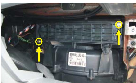
**PL** Odkręcić wkręty mocujące osłony pokrywy komory filtru
